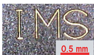
写真1 描画 SUS t 40 \mu m 貫通、 (裏面より光照射)
