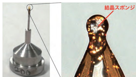
図2 ループに載せた結晶スポンジ
