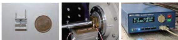
溶液試料には専用セルとセルホルダが準備されている。標準セルの容量は26マイクロリットルである。試料体積のより小さいセルでも測定可能だが、その場合は管理者と事前に相談のこと。試料温度は4～100℃の範囲で制御可能である。個体試料（フィルム、ファイバーなど）についても専用の試料ホルダを用いて測定できる（温調はなし）。
