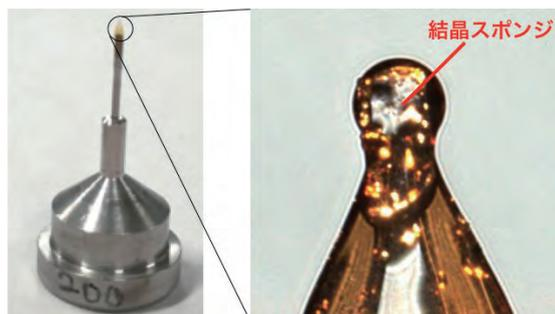
図2 ループに載せた結晶スポンジ
