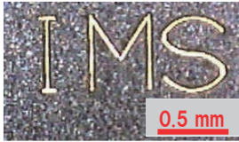
写真1 描画 SUS t40 \mu\text{m} 貫通 (裏面より光照射)
