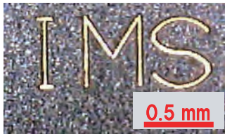
写真1 描画 SUS t 40μm 貫通 (裏面より光照射)
