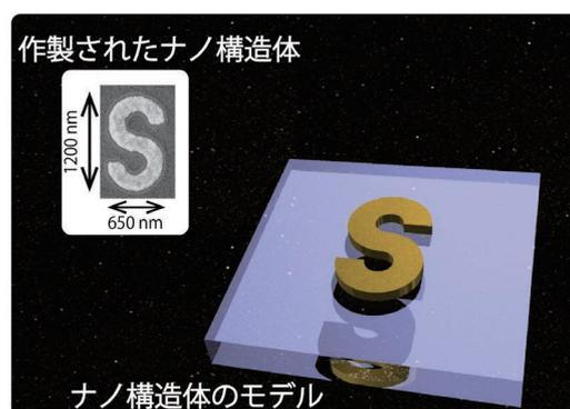
図1 電子線描画法で作製したS型ナノ構造体
