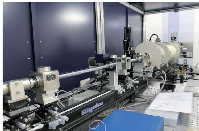
図3 X線溶液散乱計測システム
