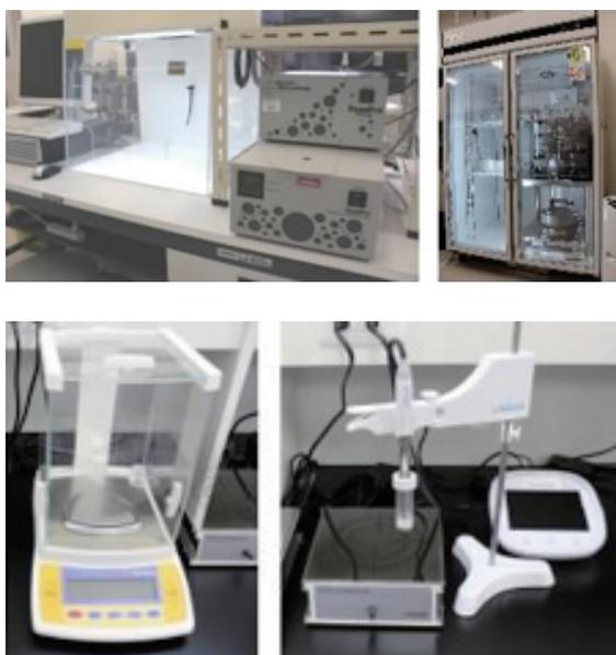
iMSaxs の周囲には生化学実験を行うための機器類が整備されており、タンパク質をはじめとする生体高分子試料の調製や評価ができる。主な機器としては、微量分光光度計 (NanoPhotometer P330, Implen)、電子天秤 (CP3202S, CP224S, Sartorius)、pH 計 (LAQUA F-73, HORIBA)、高速液体クロマトグラフィー (AKTA - FPLC, GE)、動的光散乱 (DynaPro Titan, Wyatt)、卓上クリーンベンチ (Clean Booth BB-100, AS ONE)、超音波洗浄機 (1510J-MT, BRANSON)、微量透析システム (Bio-Tech, COSMO BIO) などがある。
