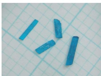
図4 1,5-ナフタレンジスルホン酸イオンを含む銅水酸化物の単結晶。
